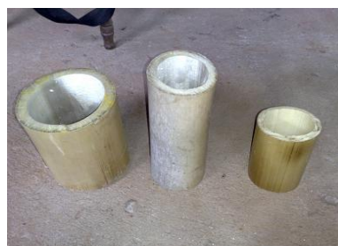
Figura 2.5 Corte de colmos de Dendrocalamus giganteus , bambusa Vulgares e Phyllostachys aurea respectivamente nessa ordem.
