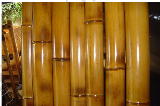
Figura 3.39. Uso de verniz. Aumenta a vida útil e melhora a estética da estrutura.
