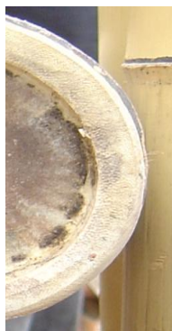
Figura 2.6. Parede do colmo de Phyllostachys heterocycla pubescens
