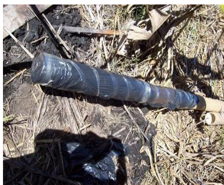
Figura 3.1. Impermeabilização da vara com saco plástico para ser enterrada.
