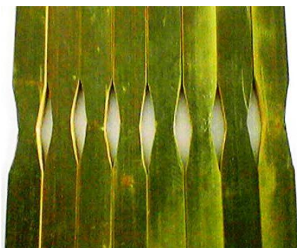
Figura 2.10. Corpos de prova submetidos a testes de tração. (Fonte: Rafaela Gomes)
