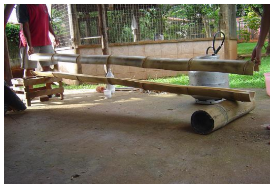
Figura 2.18. Corte feito no sentido das fibras com o uso de um facão e martelo.
