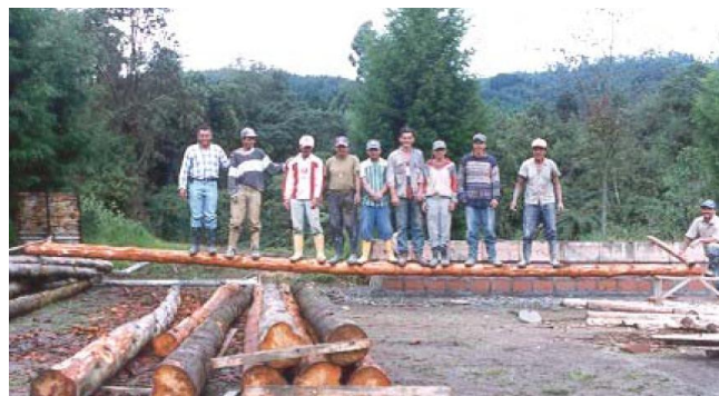
Figura 2.14. Exemplo de carga distribuída em uma peça submetida a flexão estática.
