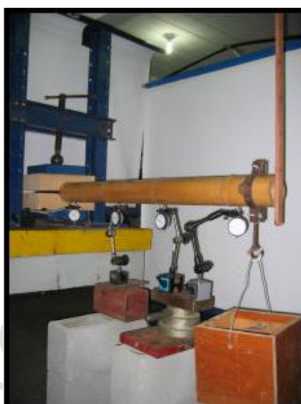
Figura 2.12. Ensaio a Flexão em uma amostra de bambu.
