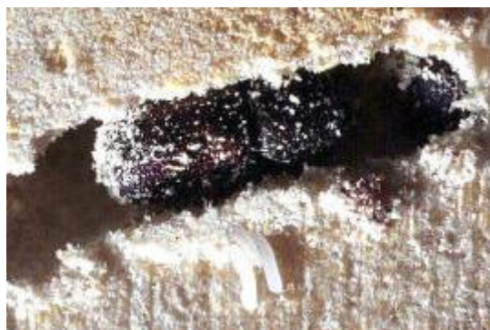
Figura 1.3 Broca do bambu ou caruncho dentro do bambu.
