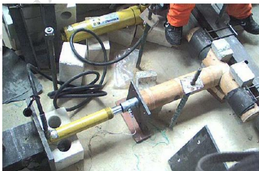
Figura 3.23. Teste de compressão na Conexão SV 90°
