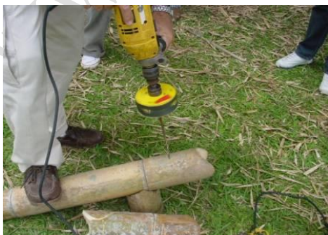
Figura 3.8. Serra copo usada para confecção da boca de pescado.
