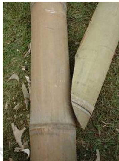
Figura 3.14. Encaixe entre peças
